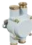
Cassette tipo UNAV 2161 in ottone verniciato grigio marina, con morsettiera e pressacavi UNAV 1948 IP66
