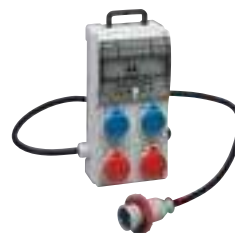
Quadri mobili a 4 prese fisse, protezione magnetotermica e differenziale 50-60Hz IP66
